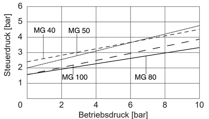
Der im Diagramm abgebildete Steuerdruck in Abhängigkeit des vorherrschenden Betriebsdrucks dient hier zur Orientierung für einen membranschonenden Betrieb.
