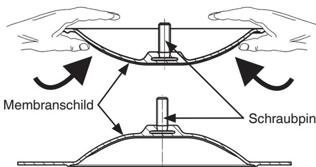
5. Neue Stützmembrane auf Druckstück auflegen.
