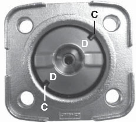
Druckstück lose auf Antriebsspindel auf-setzen, Aussparungen (D) in Führungen (C) einpassen. Das Druckstück muss sich frei zwischen den Führungen bewegen lassen!
