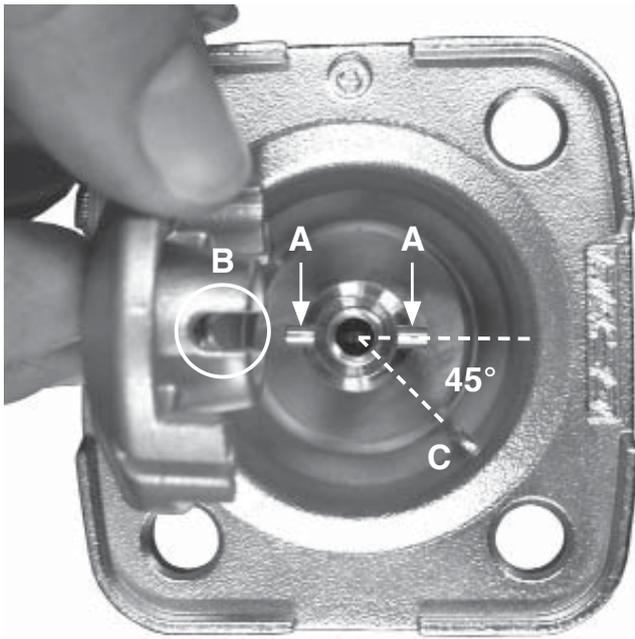
Ist die Antriebsspindel nicht in der richtigen Position, muss sie in die richtige Position gedreht werden. Die Position der Verdreh-sicherung (A) ist gegenüber der Position der Druckstückführung (C) um 45° versetzt.
