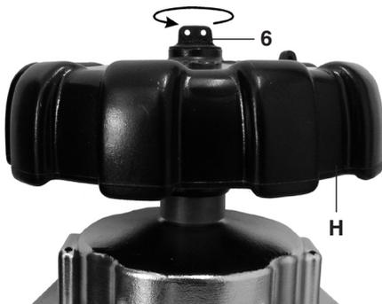
2. Arretierungsschraube 6 lösen, heraus drehen und entfernen.
