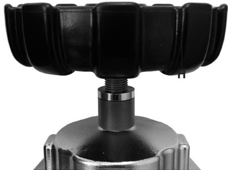
6. Handrad H 180° verdreht auf den Vierkant der Gewindespindel aufsetzen.
